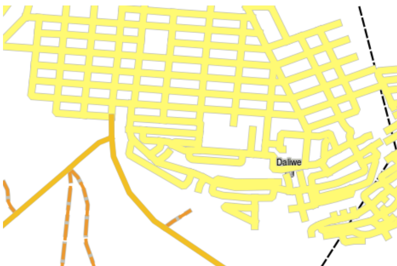
Figure 4.14: Une couche vectorielle de routes symbolisée en utilisant une valeur unique par type de route.
