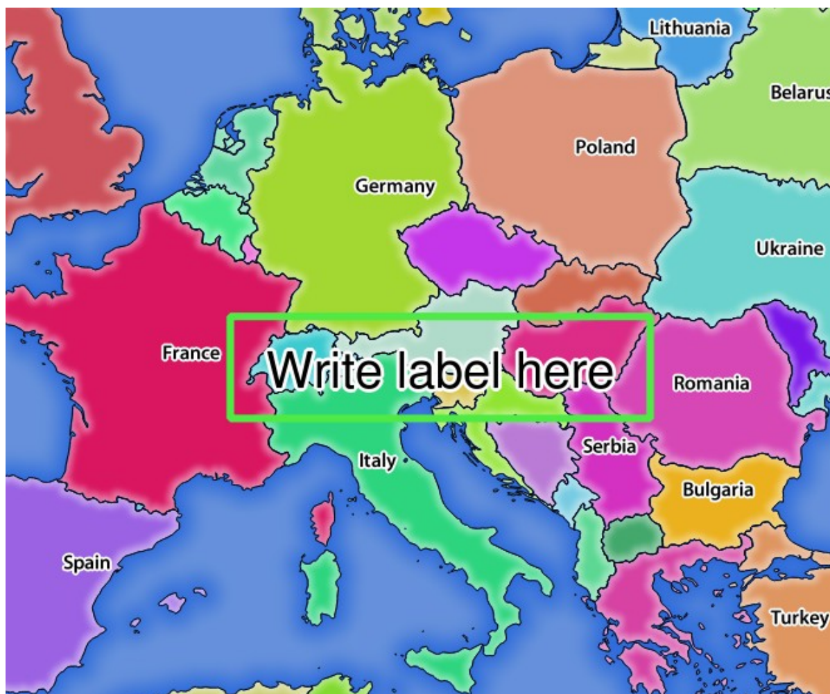
図 3.21: レッドラインパラメーターを持つ GetMap リクエストに対するサーバーの応答
